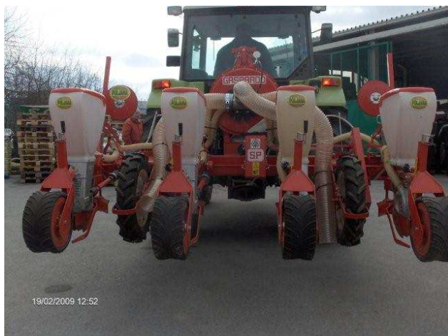
Slika 3: Prva nadograđena podtlačna pneumatska sijačica samougradnjom u Požegi
